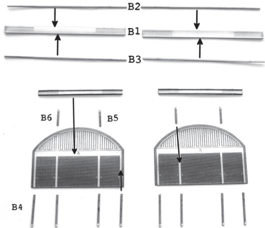
Das geschlossene Geschäftsportal passt in alle geraden Bogensegmente. Achten Sie bei der Montage auf die genaue Ausrichtung anhand der Markierung. Unten muss noch ein Spalt für den Sockel der Bodenplatte übrig bleiben.
